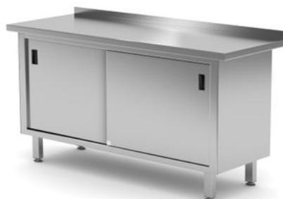
Aus AISI 430 Edelstahl, geschweißter Korpus, Arbeitsplatte mit Stahlprofilen verstärkt. Mit 40 mm Aufkantung für eine verbesserte Hygiene. Verstellbare Füße auf quadratischem Profil. Eine abnehmbare Ablage, nicht verstellbar. Schiebetüren montiert auf Rollenlagern. Vertikaler Türgriff.
