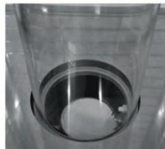
**KROK 10:** Uchopte skleněnou trubku (G) a vložte jednu stranu skleněné trubky do krytu plamene (B), dokud se nedotknete horní části krytu plamene. Potom vložte druhou stranu skleněné trubky (G) do středu skříně na láhve (horní část sestavy hořáku).
