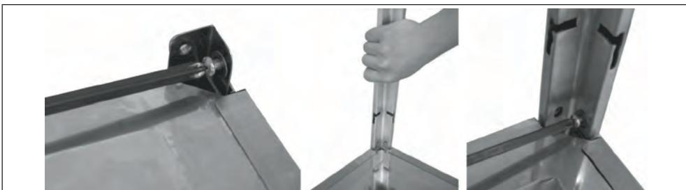
**KROK 6:** Z hornej časti zostavy plášťa zásobníka (K) vyskrutkujte 8 štandardných skrutiek s podložkami (BB). Zmontované horné diely ohrievača zdvihnite a umiestnite ich na plášť zásobníka. Nosnú lištu zatlačte, ako je to znázornené na obrázku, a uistite sa, že každá nosná lišta je zasunutá do otvoru. Na spodku ich upevnite pomocou 8 štandardných skrutiek s podložkami (BB).
