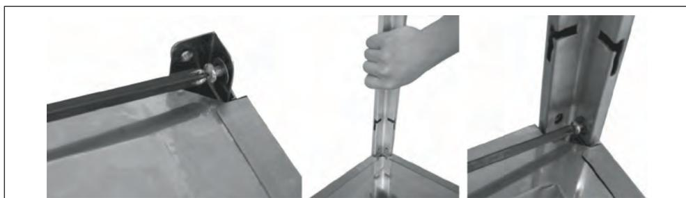
**ШАГ 6:** Выкрутить восемь стандартных болтов и шайб (BB) из верхней части корпуса бака (K). Поднять смонтированные верхние части обогревательной лампы и установить на корпус бака. Просунуть ноги, как это представлено на рисунке и удостовериться, что каждая из ног находится на своем месте. Прикрепить их снизу с помощью восьми стандартных болтов и шайб (BB).
