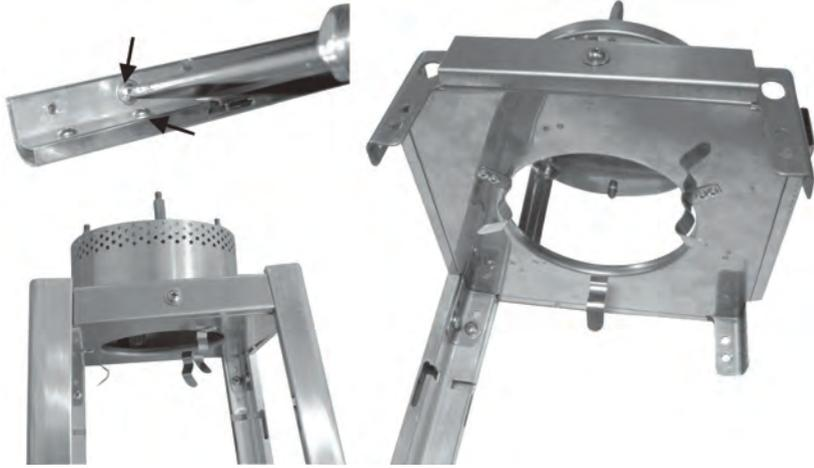
**4 ŽINGSNIS:** Atsukite 2 vnt. standartinius sraigtus ir poveržles (BB), kaip parodyta rodykleje nuo atraminio strypo – VIRŠUTINIS (E). Pritvirtinkite liepsnos tinklę (B) prie viso atraminio strypo viršaus ir pritvirtinkite naudodami 2 vnt. standartinius varžtus ir poveržles. Pakartokite šį veiksma, jei norite prijungti liepsnos ekraną (B) su kairiaisiais 3rinčiais Whole Support Bar (visos atramos juosta).
