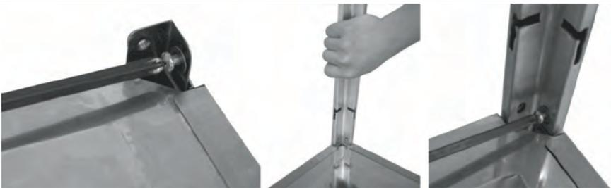
**STAP 6:** Schroef 8 standaard schroeven en ringen (BB) los vanaf de bovenkant van de reservoirbehuizing (K). Til de gemonteerde bovenste delen van de verwarming op en plaats deze op de reservoirbehuizing. Druk de steunbalk in de behuizing zoals getoond op de foto en zorg ervoor dat elke steunbalk in een sleuf wordt geplaatst. Bevestig in de onderste stand met behulp van 8 standaard schroeven en ringen (BB).
