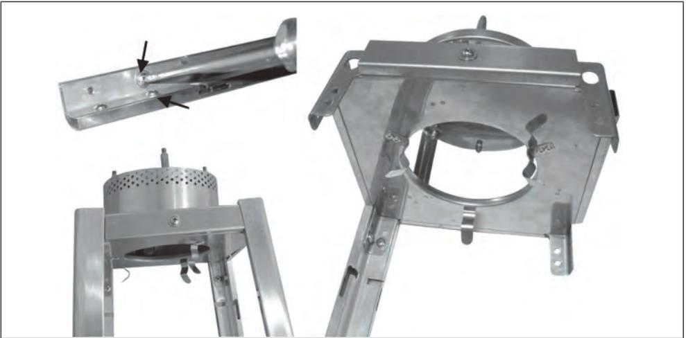
**STAP 4:** Schroef 2 standaard schroeven en ringen (BB) los uit steunbalk – boven (E) zoals aangegeven door de pijltjes. Bevestig vlamscherm (B) aan de bovenkant van de gehele steunbalk en bevestig met 2 standaard schroeven en ringen. Herhaal deze stap om vlamscherm (B) te verbinden met de overige 3 gehele steunbalken.
