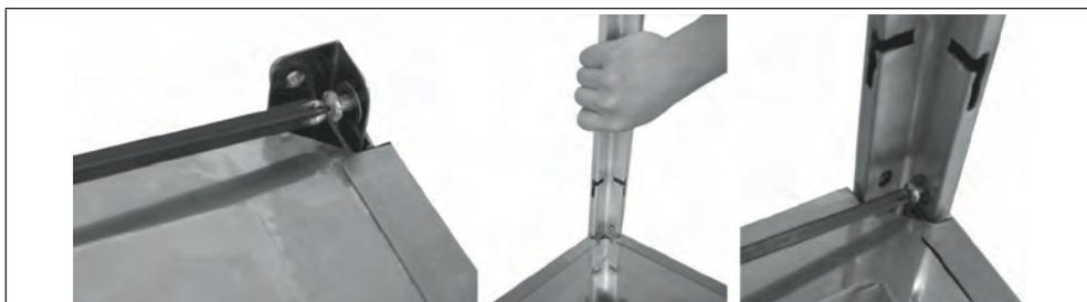
**KROK 6:** Wykręć osiem standardowych śrub i podkładek (BB) z górnej części zespołu obudowy zbiornika (K). Podnieś zmontowane górne części lampy grzewczej i umieść je na obudowie zbiornika. Wsuń wsporniki, jak przedstawiono na rysunku i upewnij się, że każdy wspornik jest wsunięty w wycięcie. Przymocuj je od dołu za pomocą ośmiu standardowych śrub i podkładek (BB).
