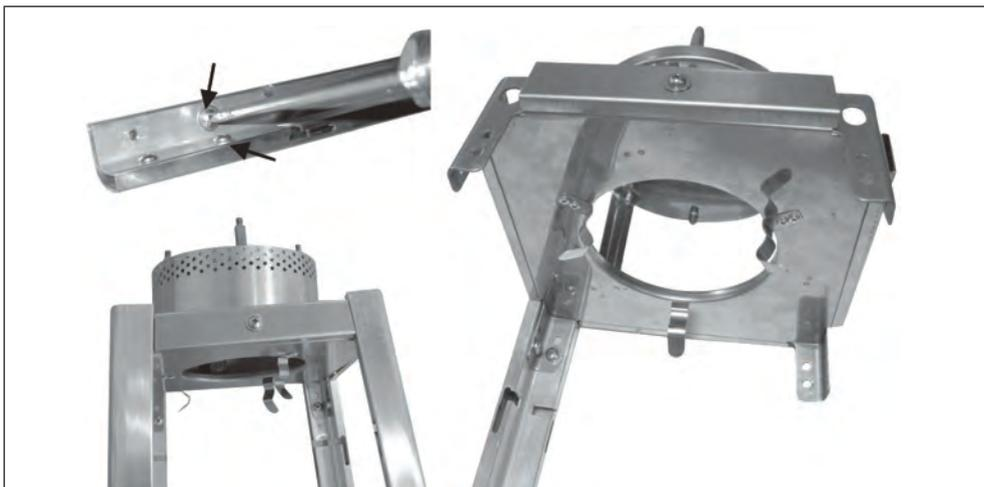
**KORAK 4:** Odvijte 2 standardna vijka i podloške (BB) kao što je prikazano strelicom na potpornoj šipki – GORNJOJ (E). Postavite zaslon plamena (B) na vrh cijele potporne šipke i pričvrstite pomoću 2 standardna vijka i podloške. Ponovite ovaj korak za spajanje zaslona s plamenom (B) s preostala 3 kompleta potpornih šipki.
