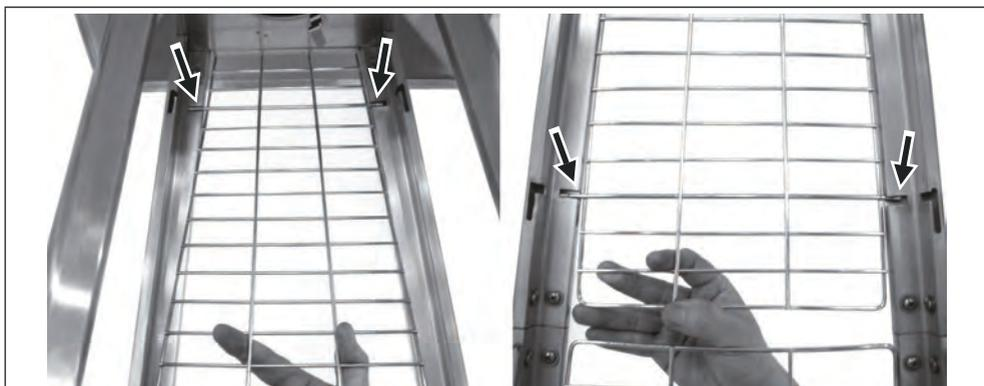
**9° PASSO:** Facendo riferimento alle operazioni del 7° passo, allineare ed inserire tre griglie di protezione superiori (C) negli incavi interni su tre supporti superiori (E).
