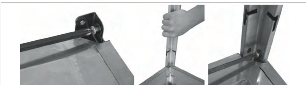
**6. LÉPÉS:** Tekerje ki a 8 darab (BB) szabványos csavart és alátétet a tartályház (K) egységének felső részéből. Emelje fel a fűtőberendezés összeszerelt felső részét és helyezze rá a tartályházra. A tartórúdat a képen látható módon nyomja bele és ellenőrizze, hogy mindegyik tartórúd valamelyik nyílásba illeszkedik. A 8 darab (BB) szabványos csavar és alátét segítségével rögzítse az alsó helyzetben.
