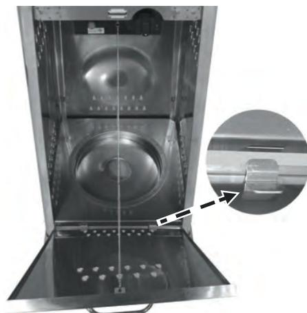
**11° PASSO:** Per montare l'ultima griglia di protezione inferiore (D) e griglia di protezione superiore (C), ripetere le operazioni del 7° e 9° passo. Rimontare quattro rotaie di fissaggio protezioni sullo schermo della fiamma (B), avvitando quattro viti con relativi dadi.
