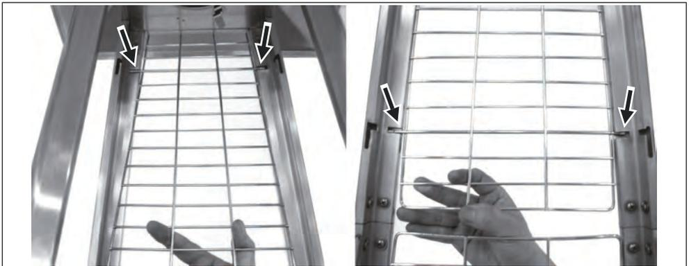
**SCHRITT 9:** Ähnlich wie im Schritt 7, Ausgleichen und Einstellen der drei oberen Schutzgitter (D) in die Innenaussparungen in den drei oberen Stützen (E).
