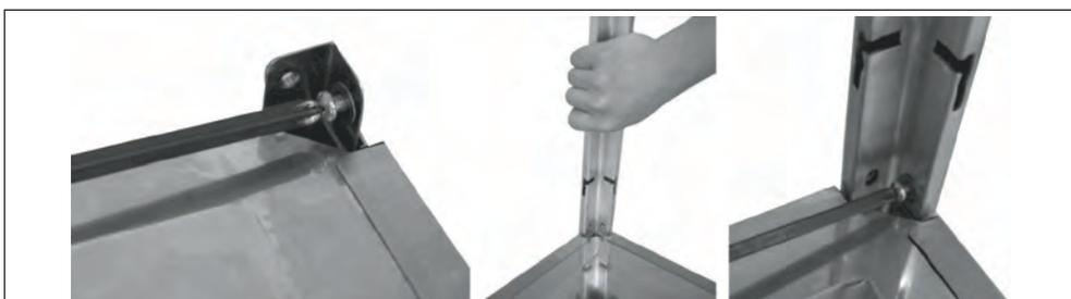
**KROK 6:** Odšroubujte 8 ks standardních šroubů a podložek (BB) z horní části sestavy skříň pro láhev (K). Zvedněte horní části ohříváče a položte je na skříň pro láhev. Ztlačte podpůrnou tyč tak, jak je ukázáno na obrázku, a ujistěte se, že každá podpůrná tyč zapadla do svého otvoru. Upevněte je v dolní poloze pomocí 8 ks standardních šroubů a podložek (BB).
