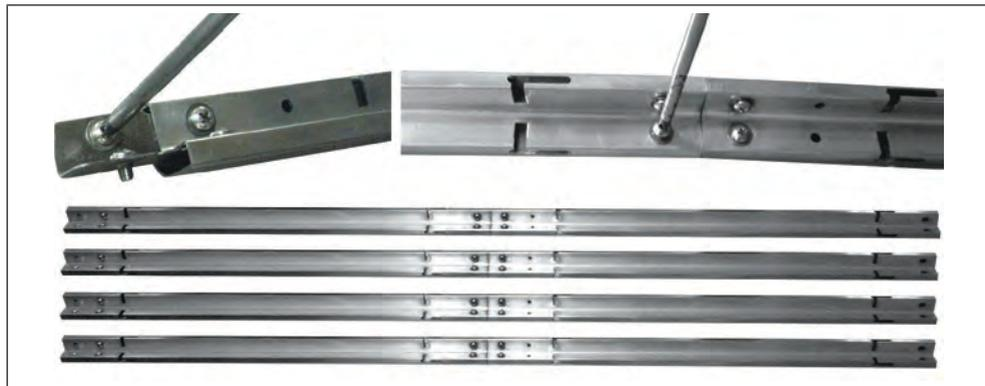
**ÉTAPE 3:** Dévisser et enlever deux vis et rondelles standards (BB) du montant inférieur (F). Placer le montant supérieur (E) dans le montant inférieur (F) et fixer à l'aide de deux vis et rondelles standards (BB). Répéter cette étape, afin de raccorder les 3 paires de montants restantes.
