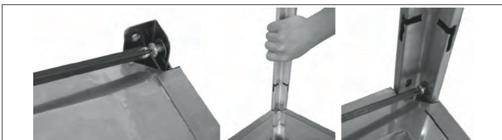
**KORAK 6:** Odvijte 8 standardnih vijaka i podloški (BB) s gornjeg dijela kućišta spremnika (K). Podignite sastavljene gornje dijelove grijalice i postavite ih na kućište spremnika. Gurnite potporna šipku kao što je prikazano na fotografiji i provjerite je li svaka potporna šipka umetnuta u utor. Pričvrstite u donjem položaju pomoću 8 standardnih vijaka i podloški (BB).
