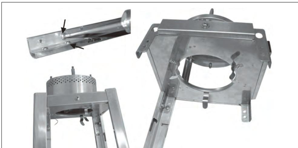
**4° PASSO:** Svitare due viti e dadi standard (BB), come indicato dalla freccia sul supporto superiore (E). Unire schermo della fiamma (B) alla parte superiore del supporto completo, mediante due viti e dadi standard. Ripetere le operazioni per fissare lo schermo della fiamma (B) ai rimanenti 3 supporti completi.
