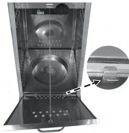
**ШАГ 11:** Повторить ШАГ 7 и ШАГ 9, для того чтобы смонтировать последнюю нижнюю защитную сетку (D), а также верхнюю (C). После этого установить четыре крепежные шины защитной крышки на экране пламени (B), используя для этого четыре болта и шайбы.
