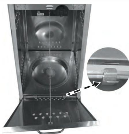
**ÉTAPE 11:** Répéter les étapes 7 et 9, afin de monter la dernière grille de protection inférieure (D) et la grille de protection supérieure (C). Installer de nouveaux quatre barres de fixation de protection sur l'émetteur du brûleur (B), en employant quatre vis et rondelles.
