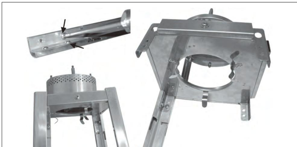
**ШАГ 4:** Выкрутить два стандартных болта и шайбы (BB) согласно стрелке на верхней части ноги (E). Присоединить экран пламени (B) к верхней части ноги и скрепить друг с другом с помощью двух стандартных болтов и шайб. Данный ШАГ повторить для скрепления экрана пламени (B) с остальными 3 ногами.
