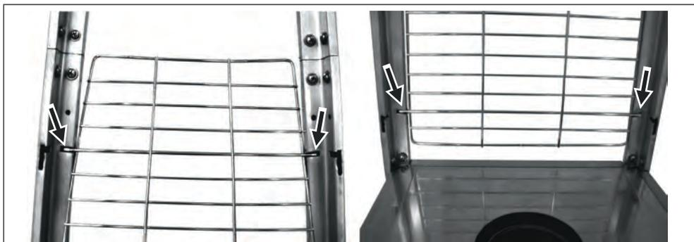
**KROK 7:** Wyrównaj i wstaw dolną siatkę ochronną [D] do wycięć wewnętrznych w dolnym wsporniku [F]. Powtórz ten krok, aby wstawić dwie dolne siatki ochronne [D].
