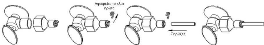
Βήμα 2: Βιδώστε τον γρήγορο σύνδεσμο στη στρόφιγγα νερού στο σπείρωμα και αφαιρέστε το κλιπ
