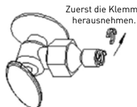
SCHRITT 2: Ziehen Sie die Schnellkupplung auf den Wasserhahn mit Hilfe von einem Gewindeelement auf und ziehen Sie die Klemme ab.
