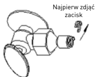
Krok 2: Nakręcić szybkozłączkę na kran elementem gwintowanym po czym zdjąć zacisk
