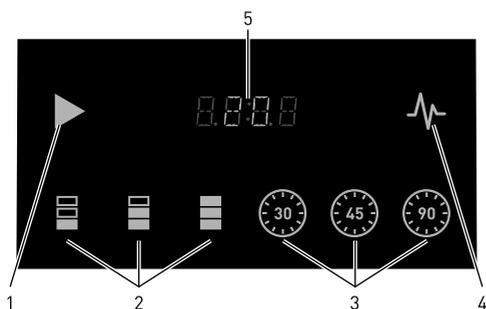
1. Comutator de alimentare ► [ON [pornit]/STANDBY [în așteptare]]: Apăsăți pentru a porni aparatul [ON]; apăsați din nou pentru a comuta la modul STANDBY
