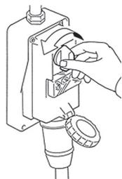
Poziționați la „zero” dispozitivul de protecție localizat înaintea liniei de alimentare a echipamentului electric.
