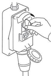
Za przewodem zasilającym urządzenia podłączyć wyłącznik zerujący.
