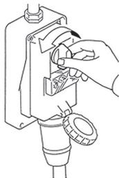
Posizionare a “zero” il dispositivo di protezione posto a monte della linea d’alimentazione dell’equipaggiamento elettrico.
